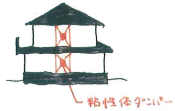
図9. 制震構造のダンパー付筋かい 粘性体ダンパー（図9）にかかった力を熱エネルギーに変換し揺れを低減している。
