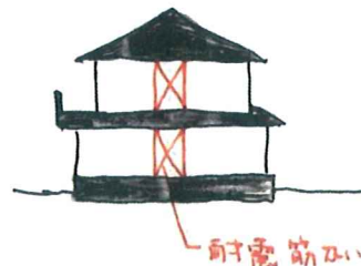
図5. 耐震構造の筋かい
