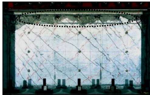
増設壁上部の支圧型破壊 (仕上げモルタル部分でのすべり破壊)
