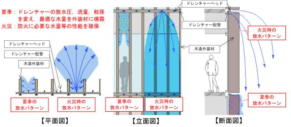
※ヘッドの取り付け位置は外装材へ組み込むなど、効果的な位置を実験や解析で検討する。
