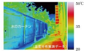
水のカーテン形成により、周囲の気温を 下げ、建物の冷房負荷を軽減する。
