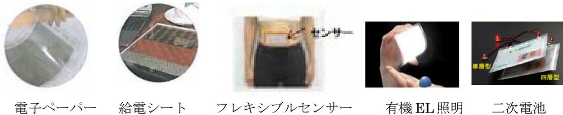
図1 プリンテッドエレクトロニクス技術例
