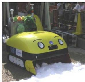
図 2-2 自立運行型除雪ロボット
