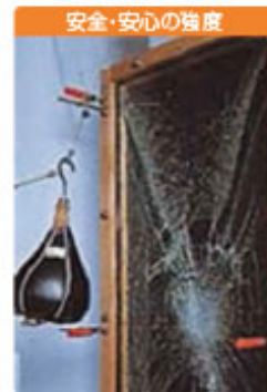
安全・安心の強度 S-LEC™ Film使用の 合わせガラス ガラス片も飛散せず貫通もしない。
