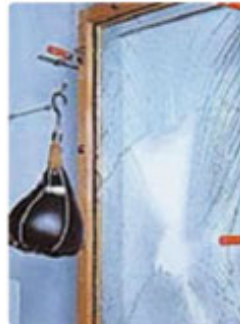
網入りガラス (6.8mm) 網が切れて、加撃物が貫通してしまう。
