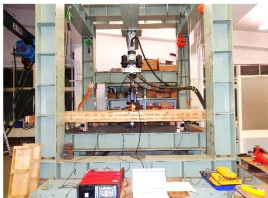
CLT 床板の面外曲げ実験
