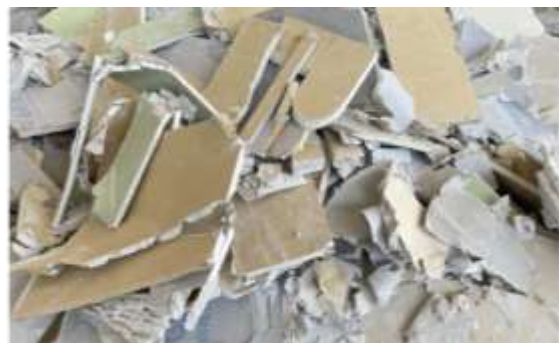
(b) 廃石膏ボード
